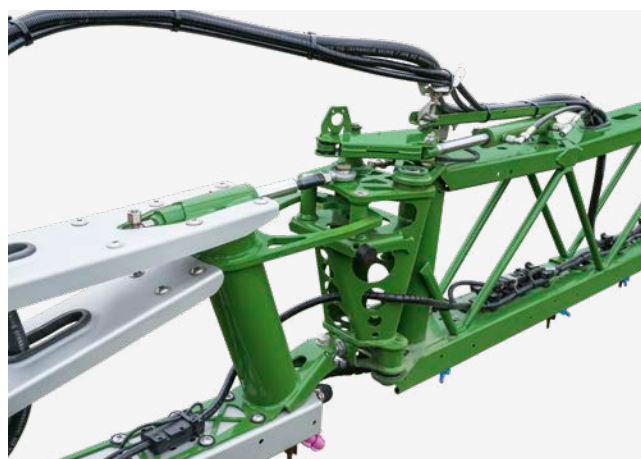
Articulation d'effacement précontrainte hydrauliquement sur le bras d'extrémité avec le principe « porte de saloon ».
