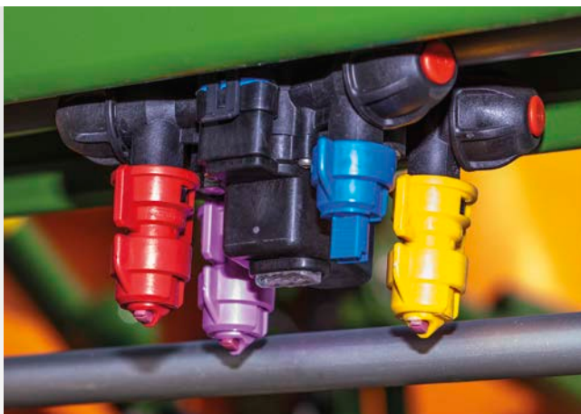
✓ Coupe électrique individuelle des buses AmaSelect
